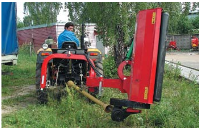
AGF-145 КОСИЛКА ЦЕПОВАЯ НА МАНИПУЛЯТОРЕ
